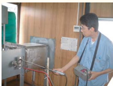
排気ダクトの測定に
